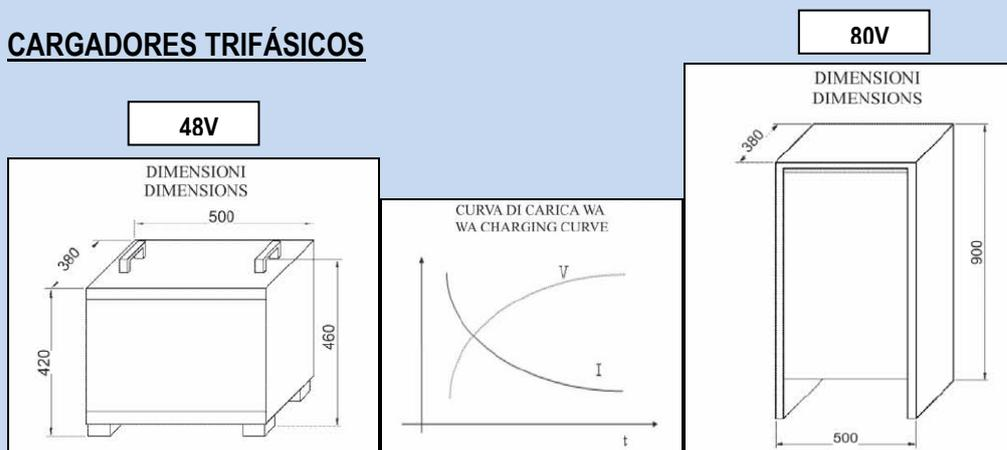
Curva de carga WA según norma DIN 41774. Control electrónico por microprocesador. Señalización del estado de carga mediante led. Indicación de la cantidad de carga con display. Memorización de los últimos 5 ciclos de carga. Protección contra sobretensión de batería. Protección contra carga continua superior a 12h. Fase de igualación al terminar la fase de carga
