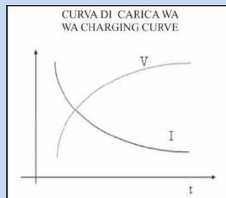
Curva de carga WA según normativa DIN 41774. Control electrónico por microprocesador. Señalización de estado de carga mediante led. Protección contra carga continua superior a 12h. Dase de igualación al terminar la fase de carga
